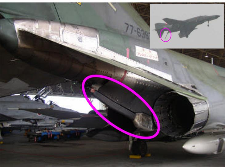
RF-4Eのアレスティング・フック。航空空母に着艦時に甲板に装備されたワイヤーに引っかけて短距離で停止させる効力を持つ。
